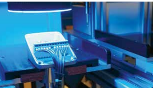
I densimetri per gas SF 6 vengono regolati e testati singolarmente per verificarne l'accuratezza.
