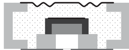
ダイヤフラムシール、オイル充填、および活性層を備えたピエゾ抵抗圧力センサーの概略断面図。
