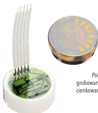
Podczas pomiaru ciśnienia membrana komórki pomiarowej czujnika ciśnienia ulega odkształceniu. Zmiana ta prowadzi do zmiany oporu elektrycznego w elementach oporowych przyłożonych do membrany. Pokazano tu przykłady technologii grubowarstwowej na ceramice (po lewej) i cienkowarstwowej na stali (po prawej).
