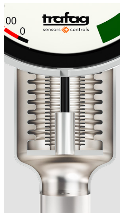
Das Herzstück des 8719-Gasdichtewächters ist die weiterentwickelte Referenzkammer. Sie ist für Drücke bis zu 13 bar ausgelegt.
