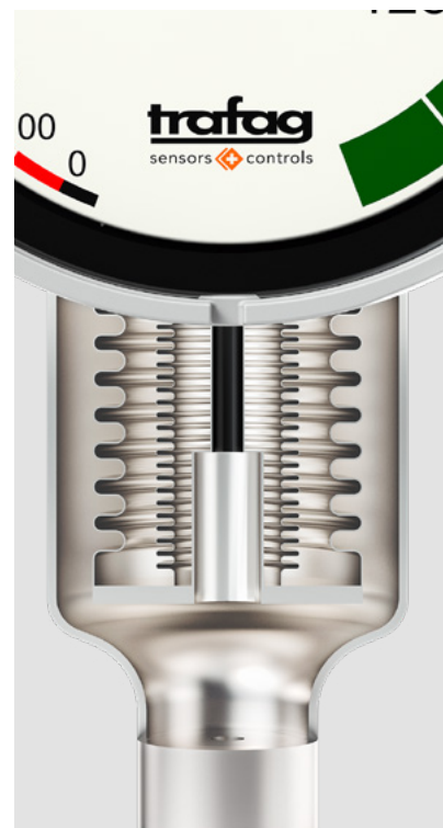
El corazón del monitor de densidad de gas 8719 es la cámara de referencia avanzada. Está diseñada para presiones de hasta 13 bar.
