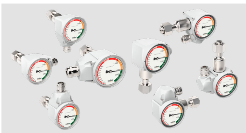
Accessibilità ottimale per ogni posizione di installazione: Design modulare nelle versioni assiali (sinistra) e radiale (destra), con connessioni nelle posizioni angolari 0°, 90°, 180° e 270°.
