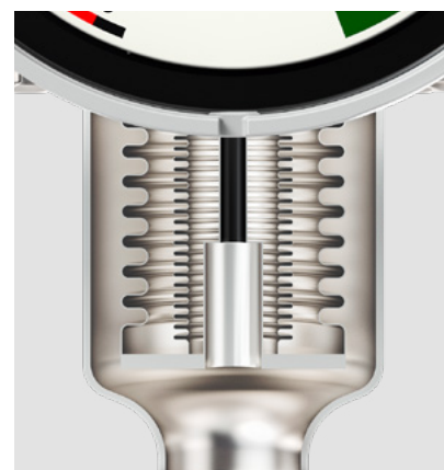
8719ガス密度モニタの心臓部は、先進的なリファレンスチャンバーです。最大13barに対応できるよう設計されています。
