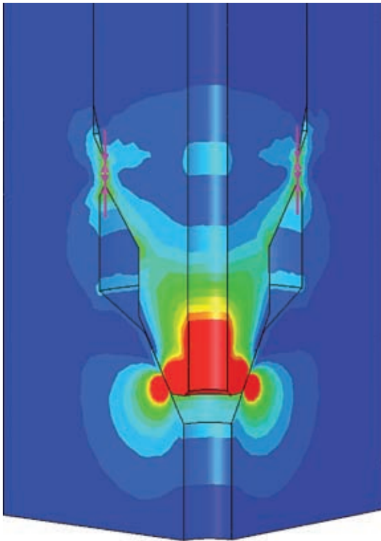
② Vergleichsspannung im Sitz während des Anziehens (links) und im vorgespannten Zustand mit Druckbelastung (rechts)
